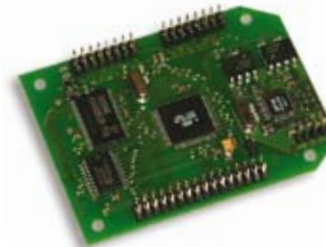
CPU-Modul des NC-Pilot mit galvanisch getrenntem USB-Port
